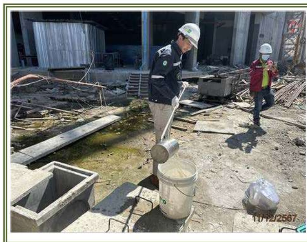
รูปที่ 3-12 การเก็บตัวอย่างคุณภาพน้ำทิ้ง บริเวณบ่อบรรณน้ำฝน
